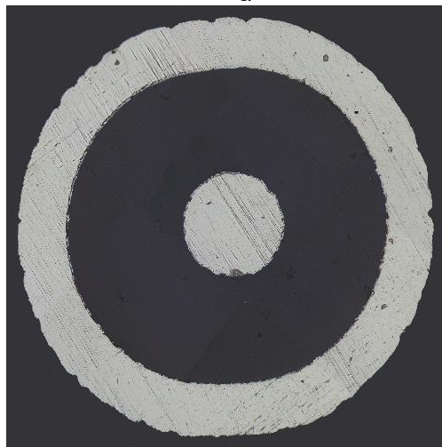
Рис. 3. Изображения поперечного сечения образцов Nb-Ti капиллярных трубок на промежуточных стадиях волочения с \varnothing 8,5 \times 0,8 мм до 1,82 \times 0,275 мм (а), в составе коаксиального кабеля без медной оболочки (б)
